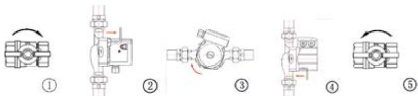
1. Закройте клапаны на входе и выходе, сбросьте давление через перепускной клапан.
